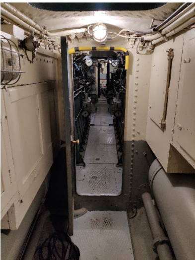
Kuva 4: Sisäpuolen oviaukot muodostavat törmäys- ja kompastumisvaaran
